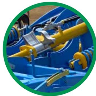
RÉGLAGE DE PROFONDEUR HYDRAULIQUE AVEC CALLES
